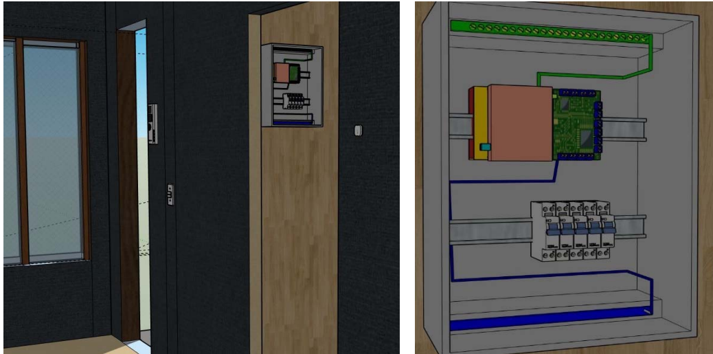
Рис. 3. Модель распределительной коробки с микроконтроллером Arduino
