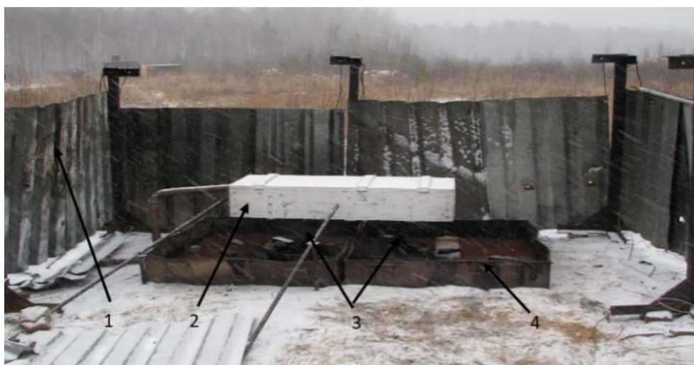
Рис. 1. Площадка испытаний с ветрозащитными барьерами: 1 – ветрозащитные барьеры, 2 – испытуемое изделие в ящике, 3 – подставки, 4 – емкость с горючей жидкостью
