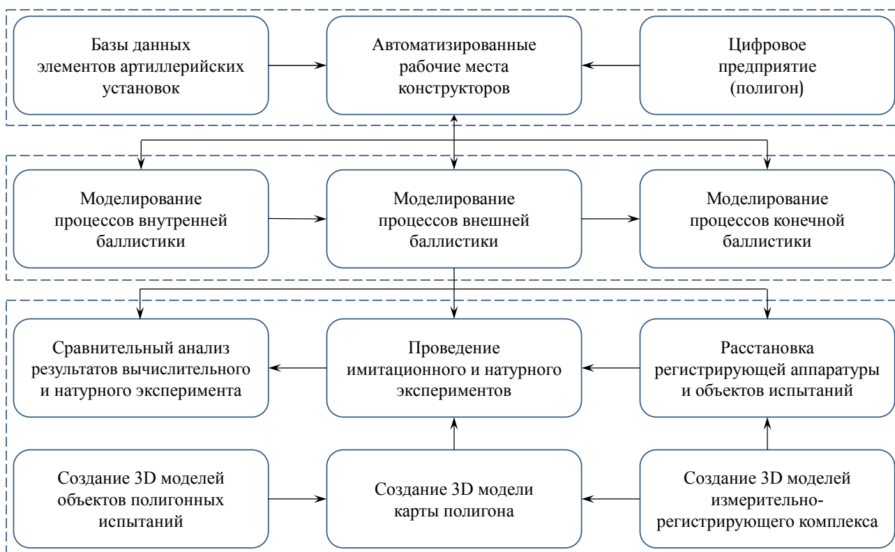
Рис. 5. Взаимосвязь процессов проектирования, моделирования и полигонных испытаний артиллерийских систем
